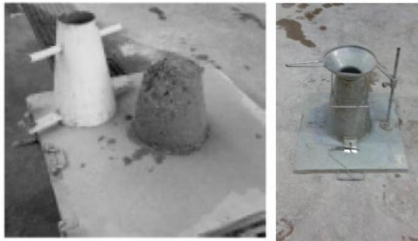
**Figure 4.11** : Photo de l'affaissement réalisé sur le cône d'Abrams
