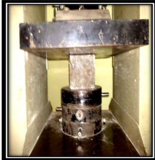
**Figure 4.12:** Essai de compression sur cube
