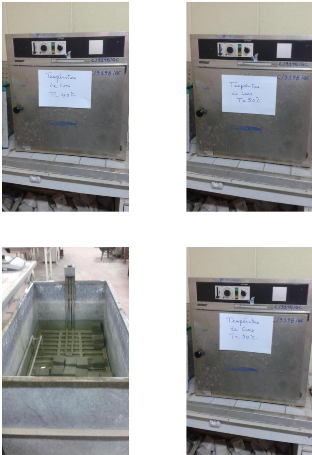
Figure 4.10 : Bacs de conservation des éprouvettes.
