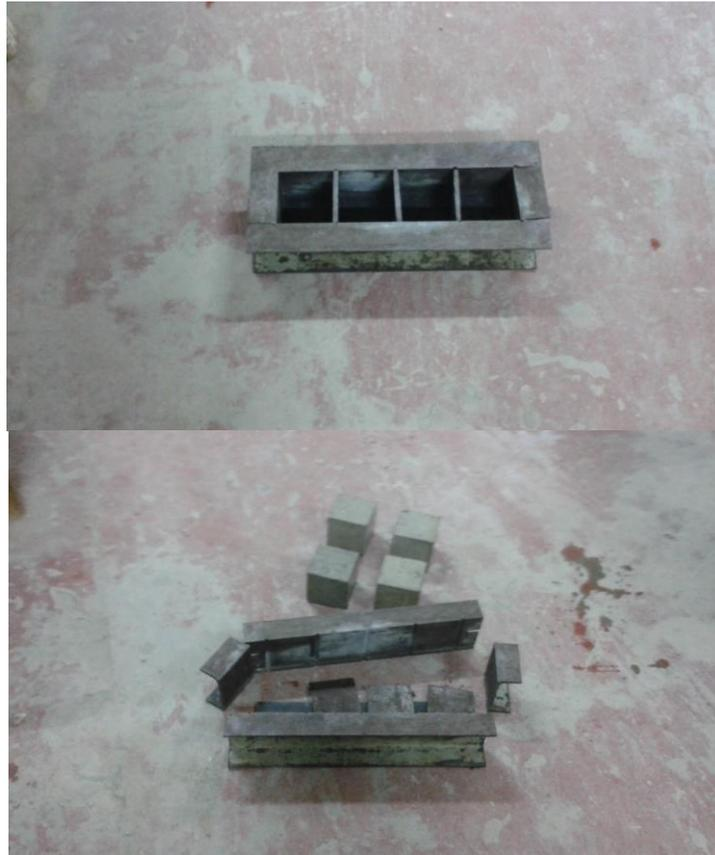
**Figure 4.9 :** Moules utilisés pour les essais mécaniques Cubiques ( $10 \times 10 \times 10 \text{ cm}^3$ )
