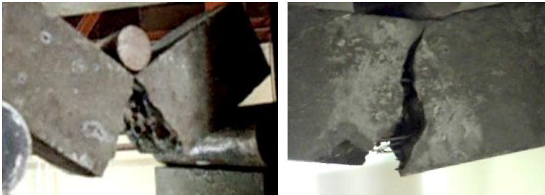
a) rupture d'une éprouvette sans fibres
