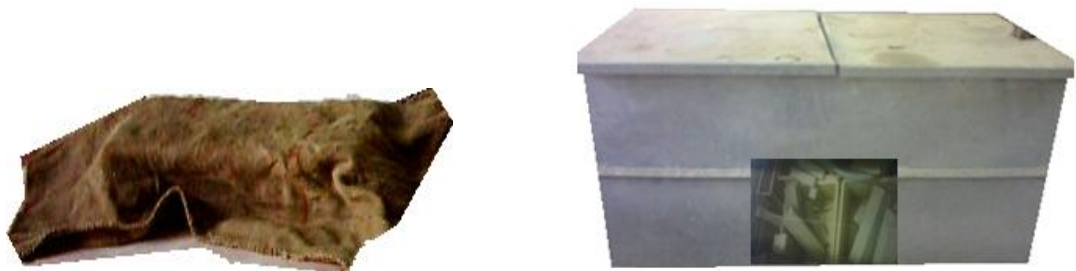
Figure 3.13: Cure sous chiffon avant 24h. Figure 3.14: Bac de conservation après 24h.
