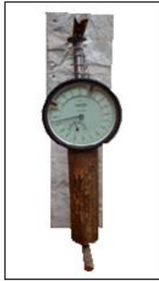
Figure 3.23: Disposition des éprouvettes lors de l'essai de retrait.
