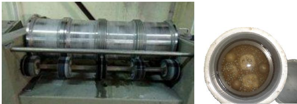
Figure 3.22: Appareil utilisée pour l'essai d'abrasion et la disposition des échantillons.
