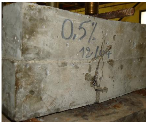
Figure 4.17 : Fissuration d'une éprouvette de 7x14x28cm.
