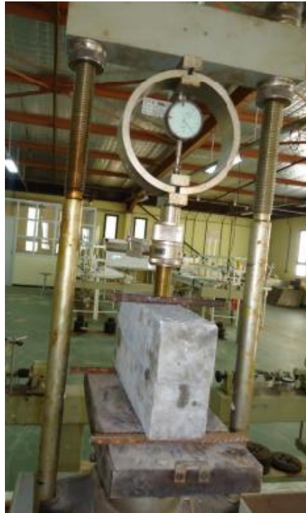
Figure 3.19: Presse CBR manuelle utilisée pour essai de déformabilité.
