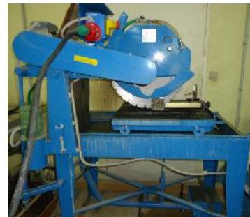
Figure 3.20: Exemple d'échantillants resultants. Figure 3.21: Tronçonneuse utilisée.
