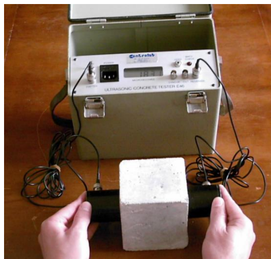
Fig. 3.8- Mesure du temps de transit par l'ultrason.
