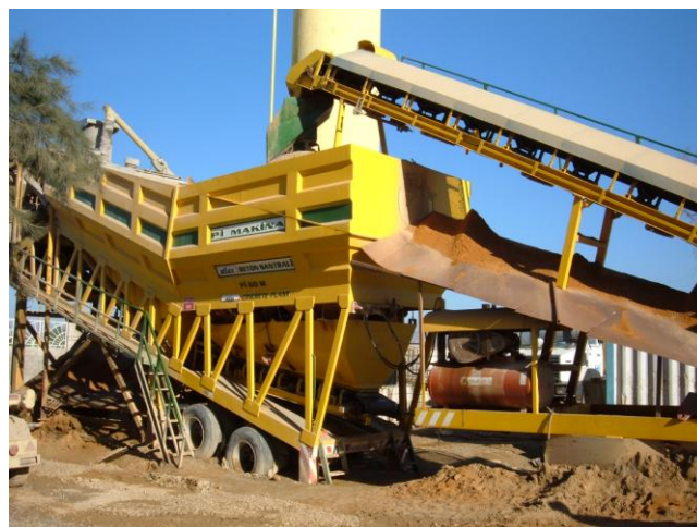
Fig. 3.15- Centrale à béton du projet n°3.
