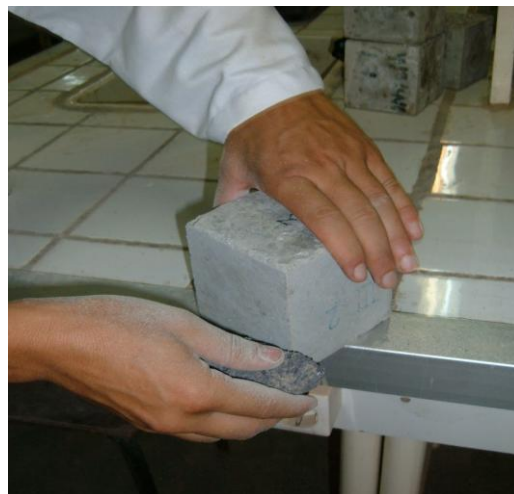
Fig. 3.6- Ponçage des éprouvettes à l'aide de la pierre abrasive.
