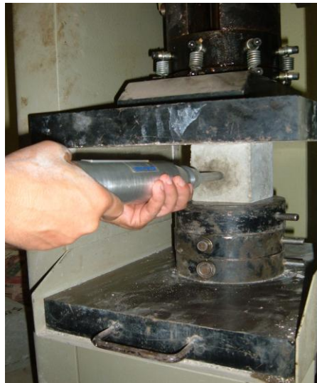
Fig. 3.9- Mesure de l'indice de rebondissement par le scléromètre.
