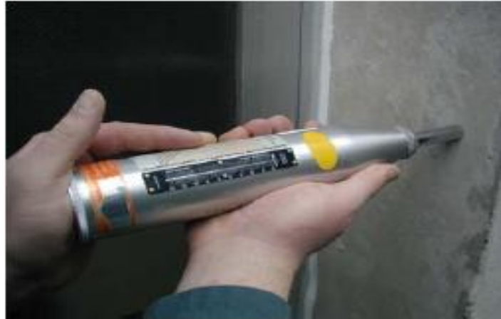
Fig. 2.6- Marteau de rebondissement de Schmidt type N en cours d'utilisation.
