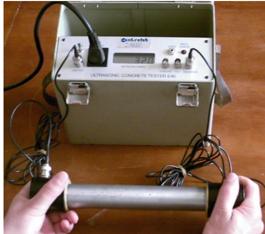
Fig. 3.7- Etalonnage de l'ultrason à l'aide du barreau.
