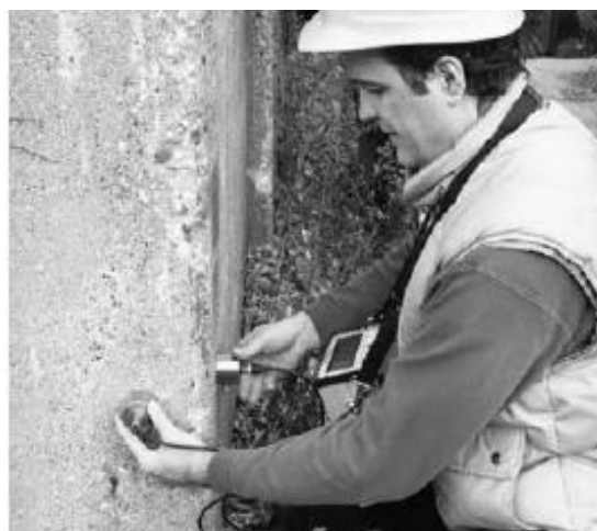
Fig. 2.17- Application de la méthode de la vitesse d'impulsion sur béton in situ.
