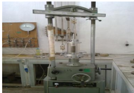
Installation de l'éprouvette dans la presse triaxiale
