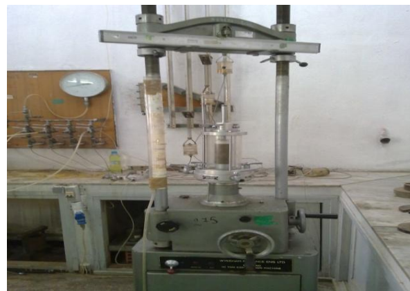
(d) installation de la cellule dans la presse.
