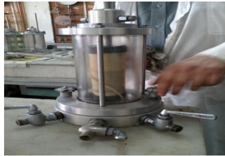
Installation de l'éprouvette dans la cellule
