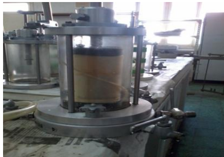
Remplissage de la cellule par l'eau
