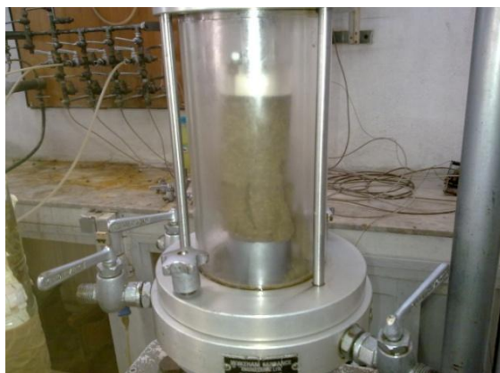
(e) écrasement de l'éprouvette (1mm/min)
