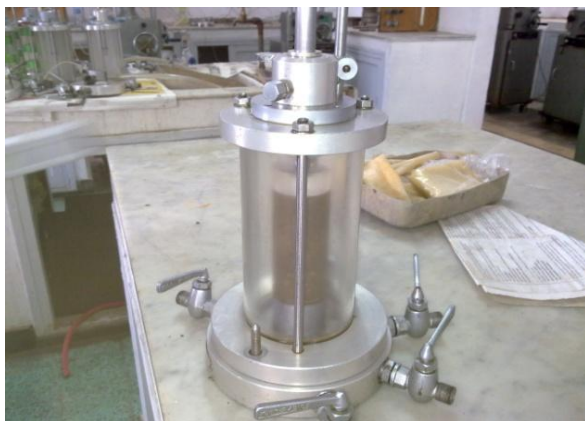
(c) installation de l'éprouvette dans la cellule
