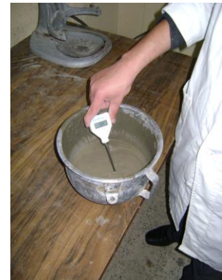
f) Mesure de la température du coulis à 5 minutes
