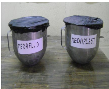
g) Couverture des récipients par un film plastique pour éviter toute évaporation d'eau
