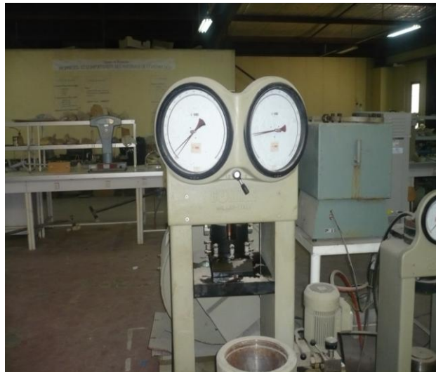
Figure 2.6. presse hydraulique pour essai de compression
