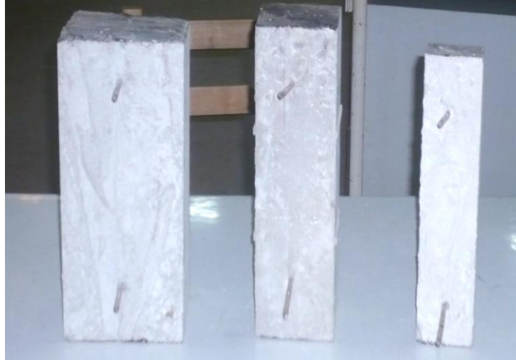
Figure 2.4. Prismes en béton pour mesurer le retrait libre
