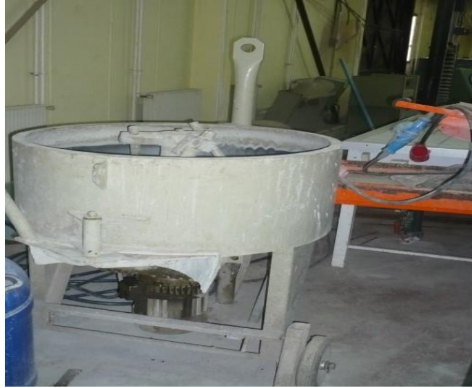
Figure 2.2 : Malaxeur à béton de capacité 100 litres.
