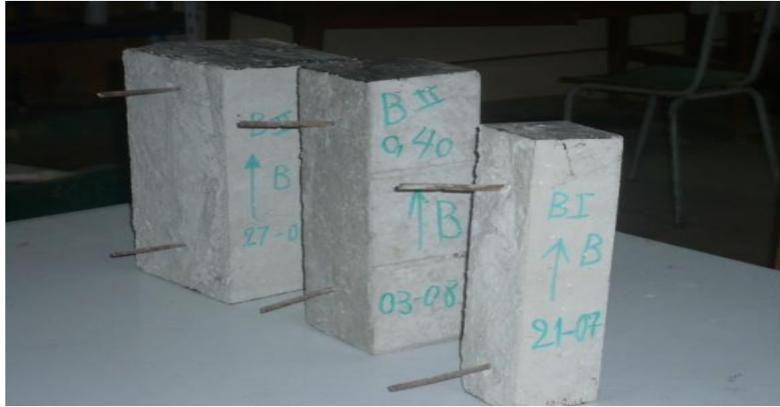
Figure 2.7: Prismes pour mesure de retrait
