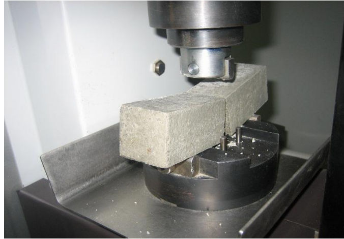
Figure 3.13 : Essais de résistance à la flexion.
