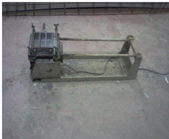
Figure 3.7 : Table à secousses pour le compactage des éprouvettes.
