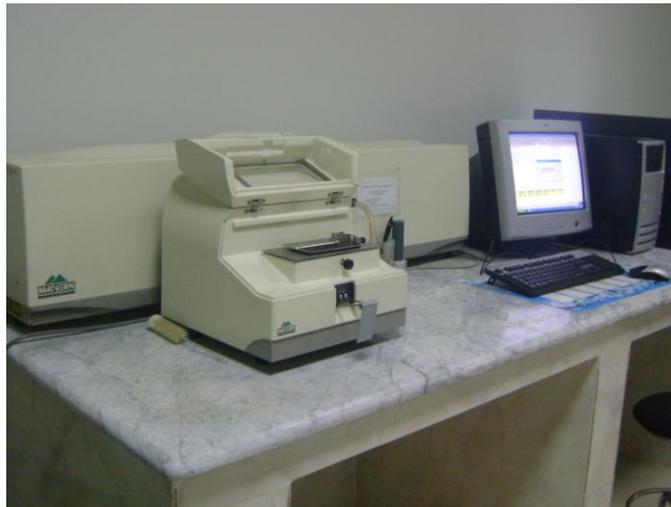
Figure 6.27 : granulomètre –laser [Laboratoire ECDE]
