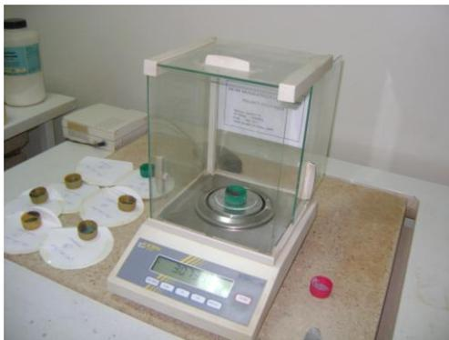
Figure 6.14 pesée de l'échantillon
