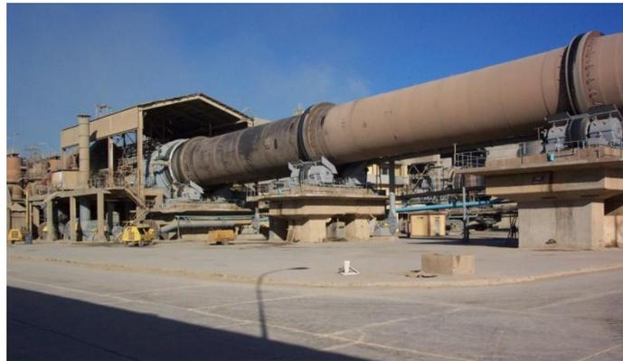
Figure 5.10 : Four rotatif de l'E.C.D.E (longueur 100m)
