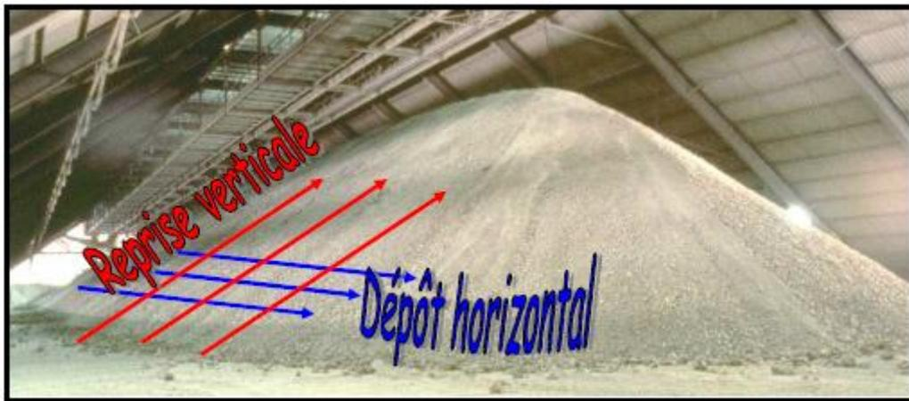
Figure 1.9 :Pré-homogénéisation du mélange calcaire-argile
