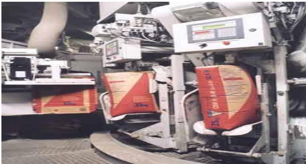
Figure 1.19 : Ensacheuse rotative
