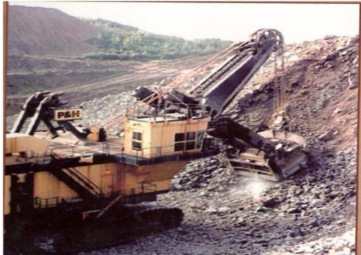
Figure 5.4 : Extraction du calcaire par pelle électrique excavatrice P.H
