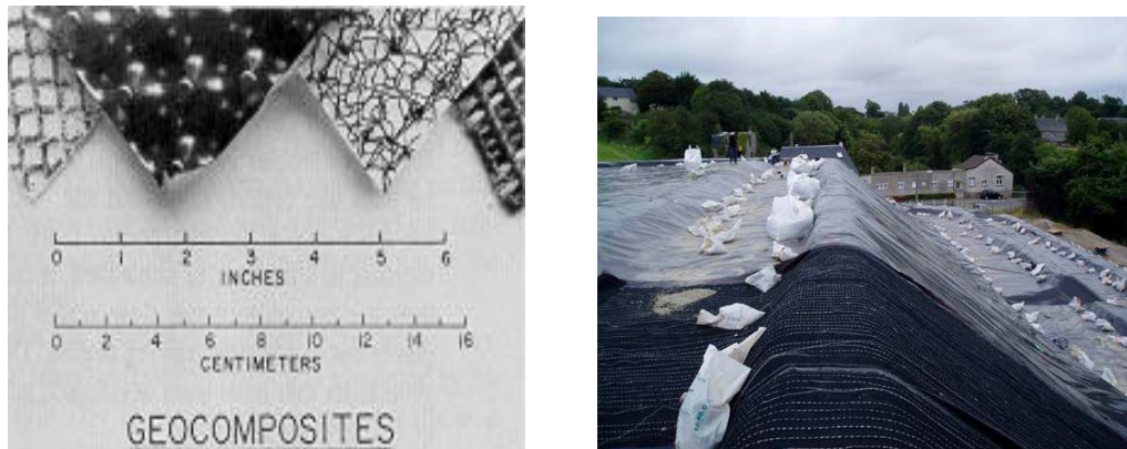
Figure 1. 11: (a) les géocomposite, (b) Talus renforcé par les géocomposites (Baziz. F.2012)
