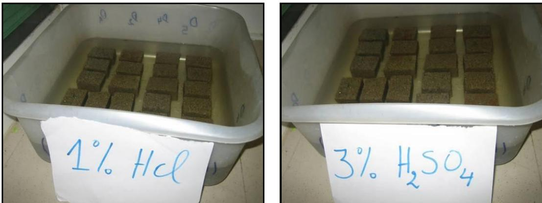
Figure V.6 : Des éprouvettes immergées dans la solution contenant 1 % HCl et 3 %  $\text{H}_2\text{SO}_4$
