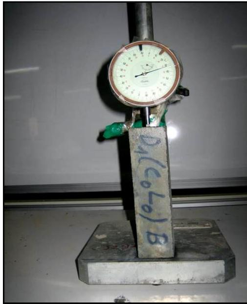
Figure V.5 : Mesure de l'expansion dans les sulfates
