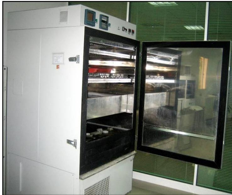
**Figure V.1** : Enceinte climatique pour conservation des éprouvettes.
