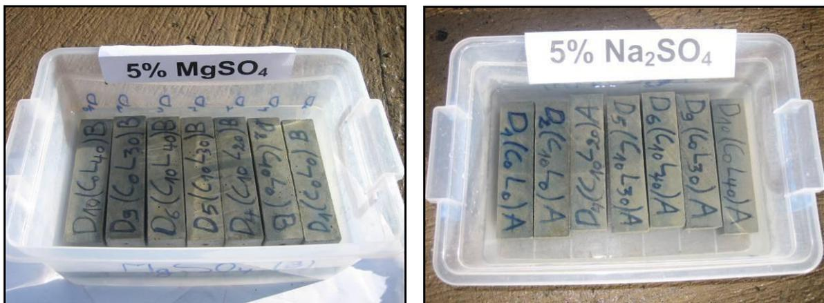
**Figure V.4 :** Immersion des éprouvettes dans les solutions de sulfates
