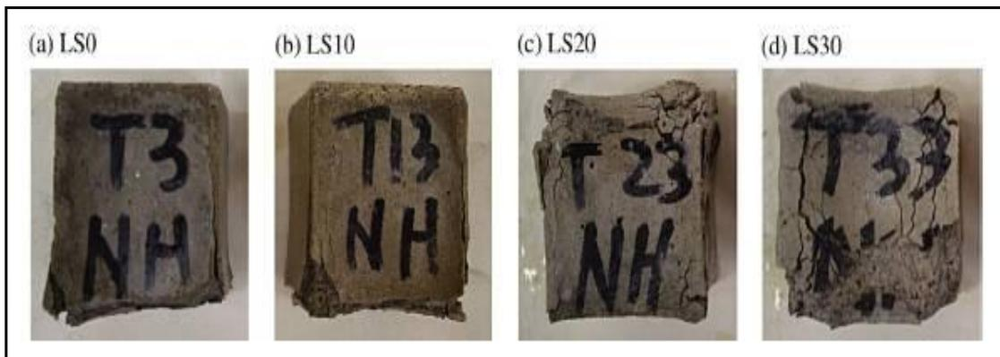
**Figure IV.23a :** Spécimens traités dans une solution de sulfate de sodium ( $Na_2SO_4$ ) à 360 jours [49].
