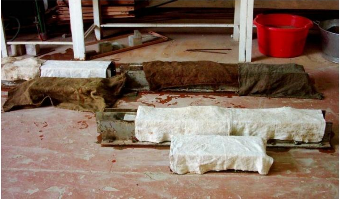
Fig. 4.3- Conservation des éprouvettes avant démoulage.
