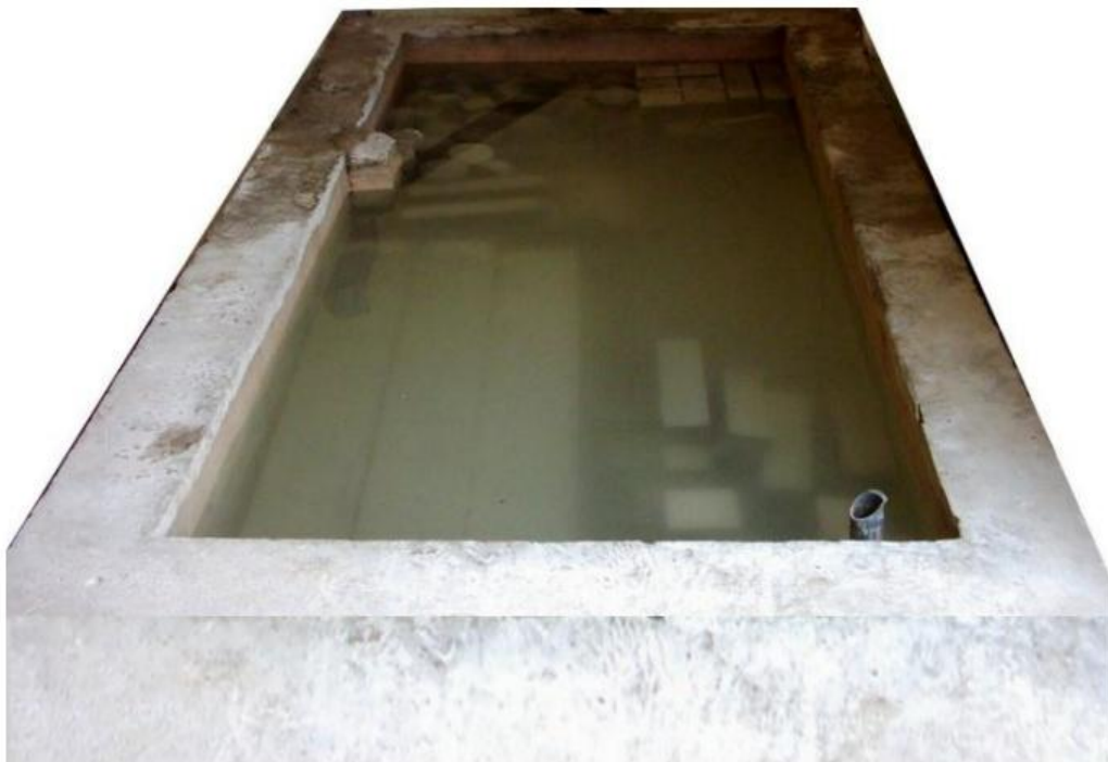
Fig. 4.4- Conservation des éprouvettes après démoulage.
