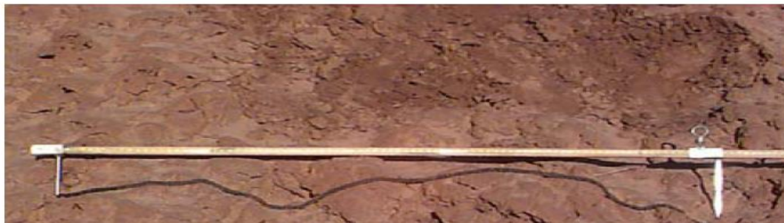
Figure 10: Exemple d'utilisation de la méthode de la chaîne avec une règle-venier.
