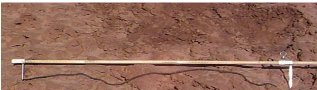
Figure 28 : Exemple d'utilisation de la méthode de la chaîne avec règle-vernier
