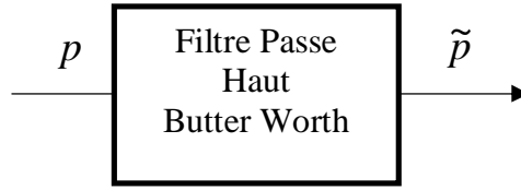
Figure (II.6): Schéma de principe du filtre utilisé pour l'extraction des composantes harmoniques
