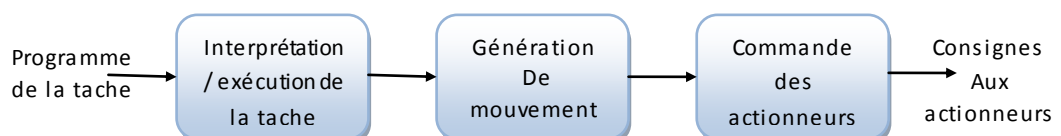
Figure 4.5. Place de la fonction génération de mouvement au sein du contrôleur de robot manipulateur
