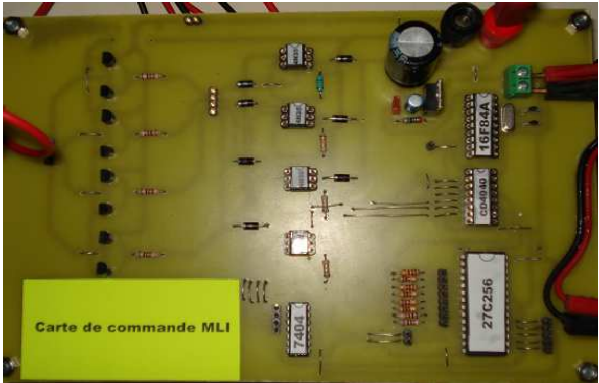
Figure21 : La réalisation de la carte MLI
