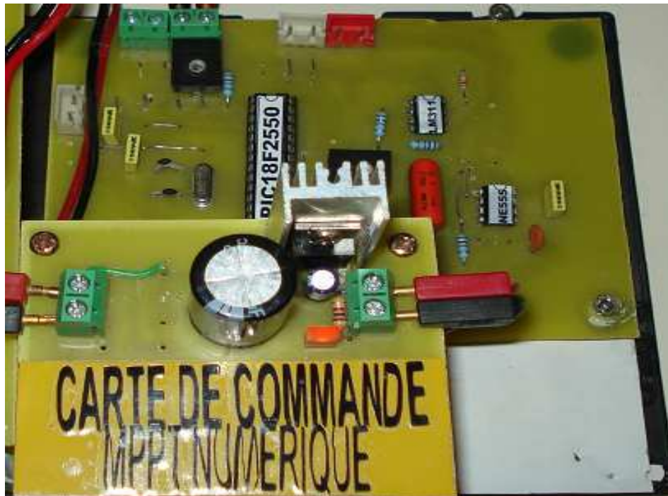
Figure V.12 : La réalisation de la carte MPPT
