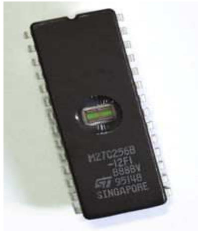
Figure III.11 : EPROM 27C256 de 256 Kibits, soit 32 Kio
