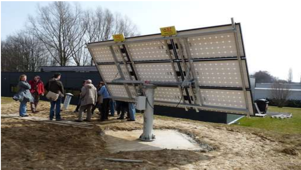
Figure (III.11) : suiveur de soleil en position [DIN11].
