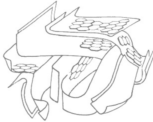
Figure I.1 : Présentation schématique des macropores et des micropores au sein du charbon actif [11].
