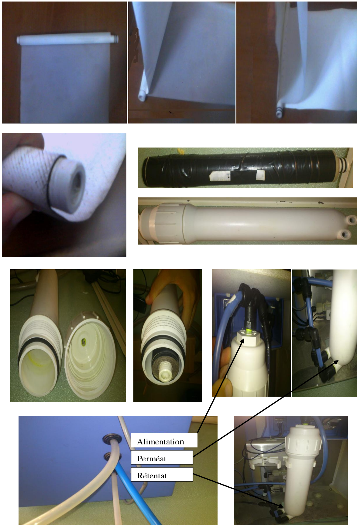
Figure IV. 23: Montage des membranes usagées dans la cellule osmoseur.
