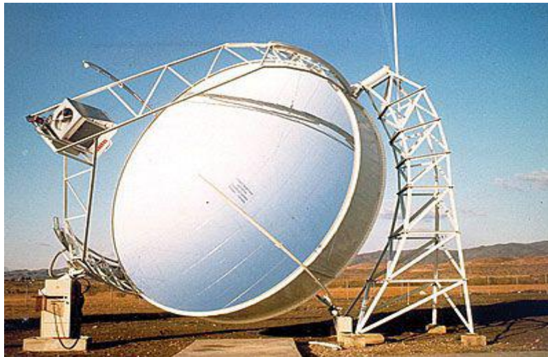
Figure II.9 : Capteur parabolique avec moteur stirling. [SW4, 11]
