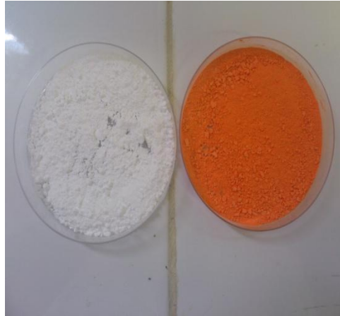
Figure V.20 l'adsorbant [Ca-Al-CO 3 ] avant et après l'adsorption du colorant SRL 150
