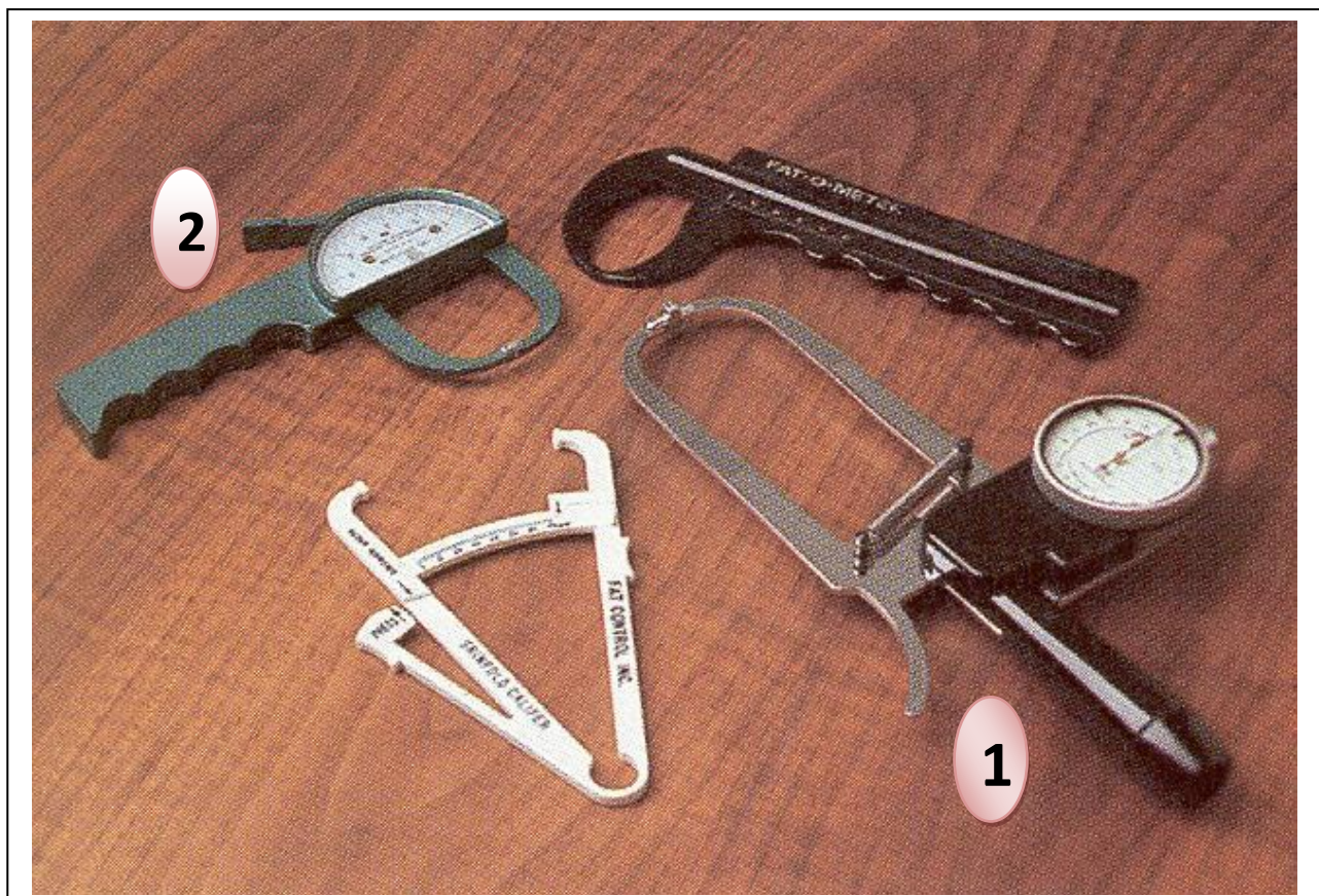
شكل (07): أنواع مختلفة من مقاييس سمك طية الجلد، ويظهر نوع هارنندن رقم (1) وكذلك نوع لانج رقم (2).
