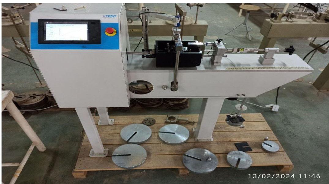
Figure 2.1 : Appareil de cisaillement utilisé dans cette étude.
