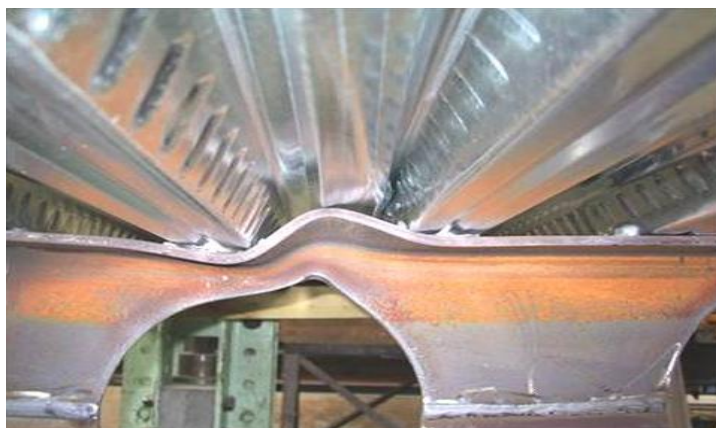
Figure 1-17 poutre cellulaire avec une ruine par flexion [11].
