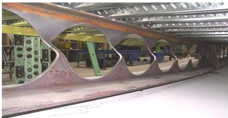
Figure 1-15 Double courbure du montant de l'âme Web-Post [11].
