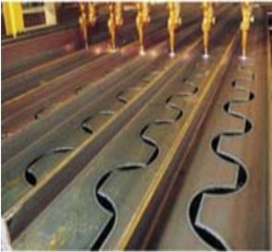
Figure 1-5 Table d'oxycoupage de poutrelles laminées à chaud [10].
