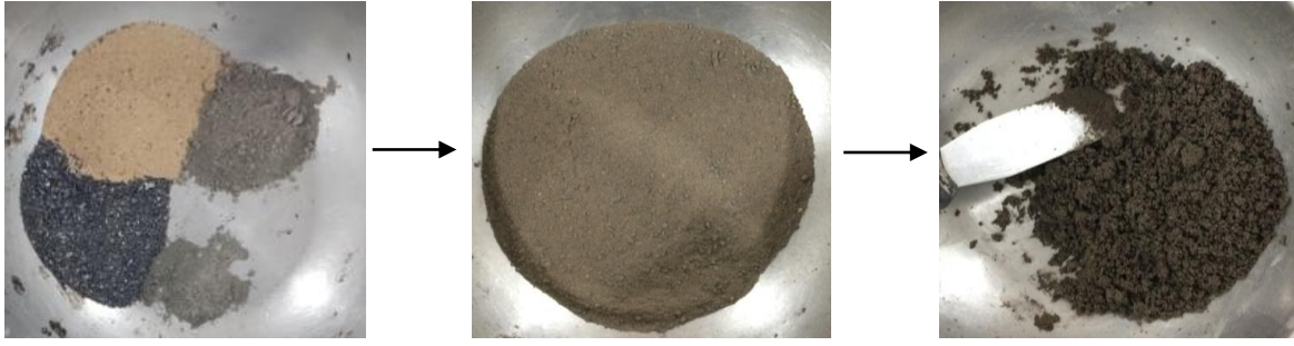
Figure II.10. Préparation des mélanges avec OMC= 14%.
