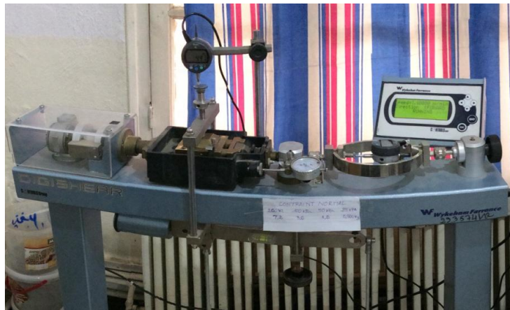
Figure II.6 : Dispositif expérimental utilisé : Boîte de cisaillement
