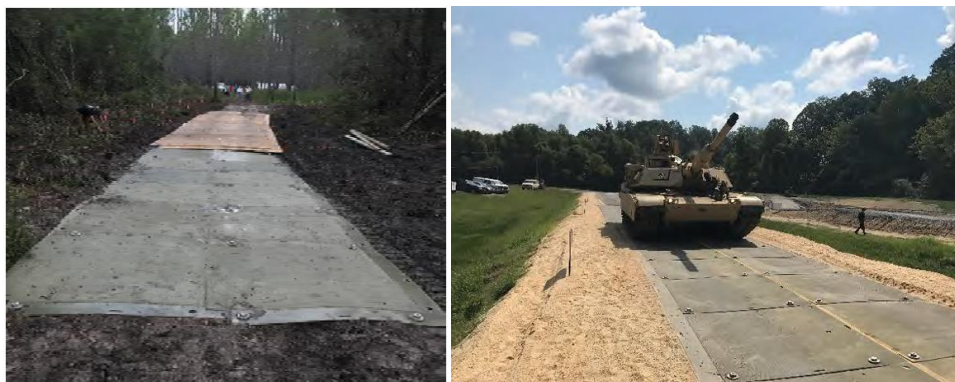
Figure.I.6 Char M1 Abrams traversant des sols sablonneux et limoneux renforcés en fibre de verre et résine polyester (ERDC), Mississippi, États-Unis.
