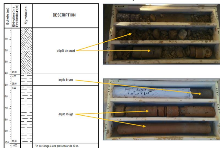
Figure IV.2 : Sondage carotté sur 10m de profondeur (SETS).
