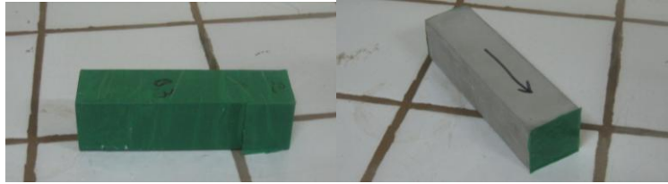
Figure 2.9 : Eprouvettes préparées pour les mesures de retrait.
