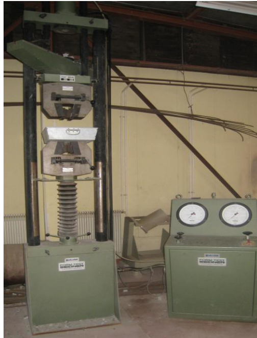
Figure 2.13 : Machine d'essai de compression simple
