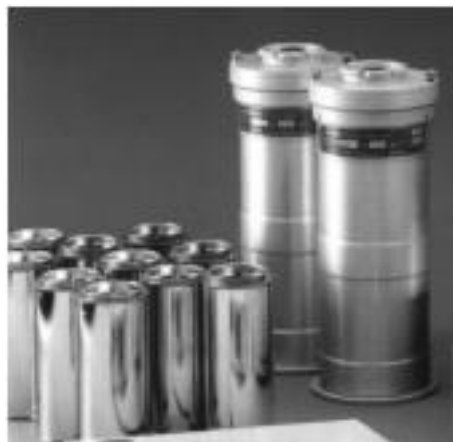
Figure 2.14 : Calorimètre de Langavant.
