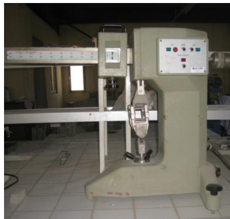
Figure 2.12 : Machine d'essai de flexion simple.
