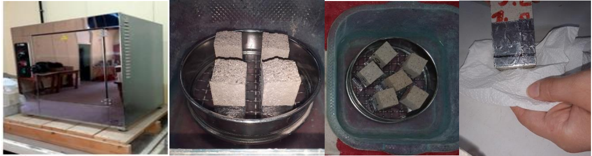
Figure 2.23 : Essai d'absorption capillaire sur une éprouvette de mortier.
