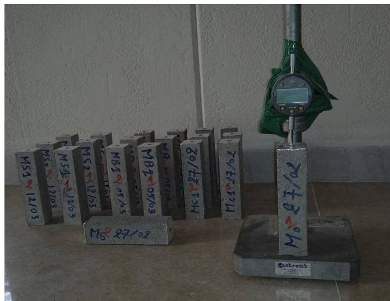
Figure 2.25 : Essai de retrait au cours de séchage sur une éprouvette de mortier.
