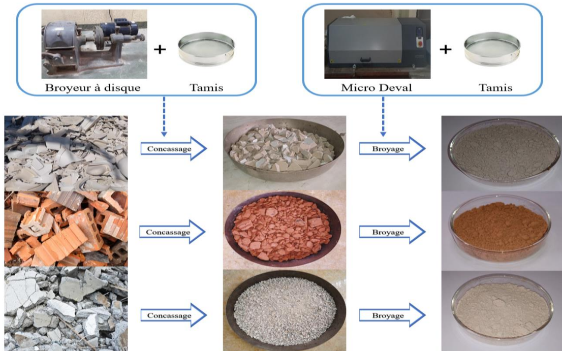
Figure 2.9 : Etapes d'obtention des fines de déchets de chantiers.
