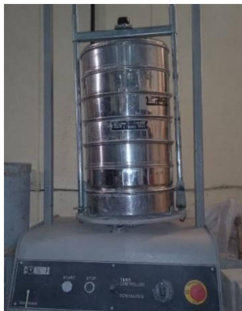
Figure 2.3 : Tamiseuse utilisée pour déterminer la granulométrie des sables.
