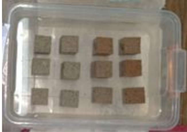
Figure 2.22 : Essai d'absorption sur une éprouvette de mortier.
