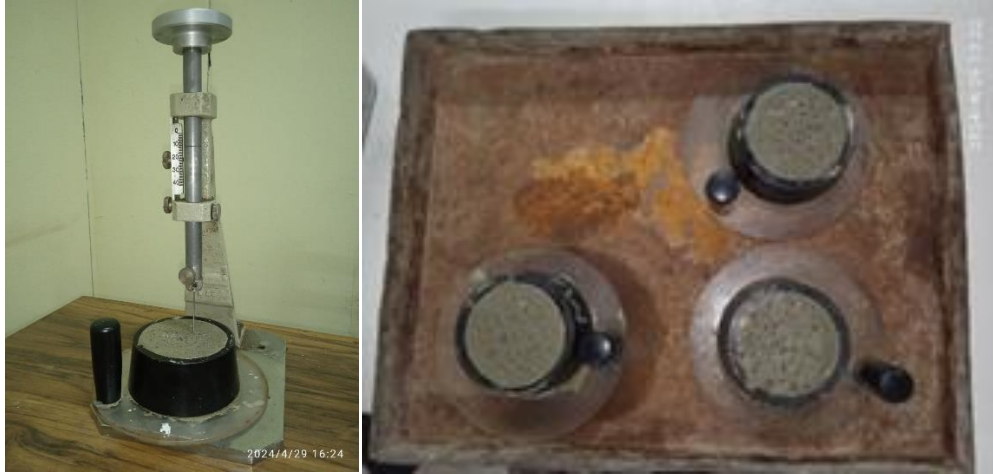
Figure 2.18: Appareil de Vicat utilisé pour déterminer la période de prise du ciment.
