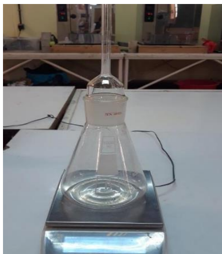
Figure 2.6 : Pycnomètre utilisé pour déterminer la masse volumique absolue d'un sable.
