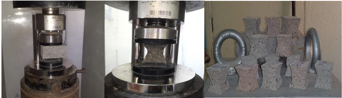
Figure 2.21 : Essai de compression sur une éprouvette de mortier.
