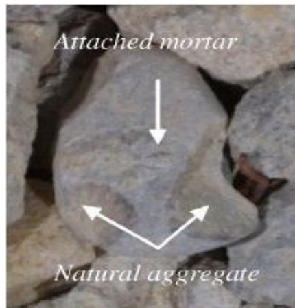
Figure 2. 6. Compositions des granulats recyclés de béton (De Juan et Gutiérrez, 2009).
