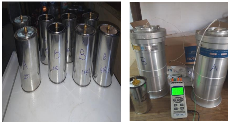
Figure 4. 13. Vue de l'essai d'analyse calorimétrique
