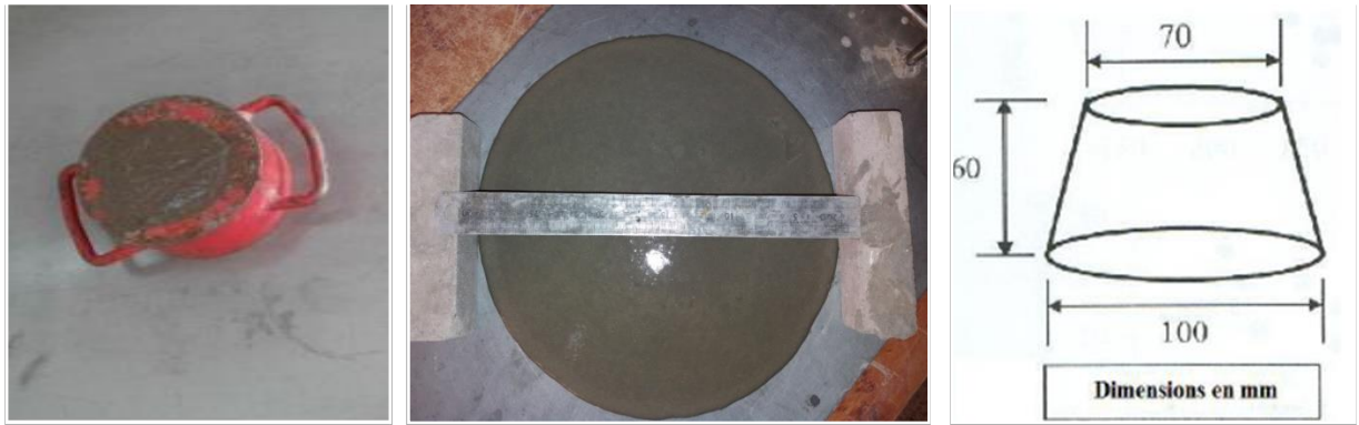
Figure 4. 10. Essai d'étalement au mini-cône.
