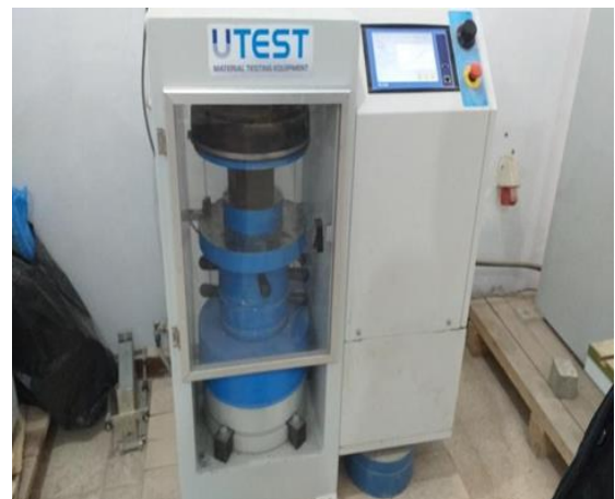
Figure 4. 18. Essai de compression avec une presse hydraulique.
