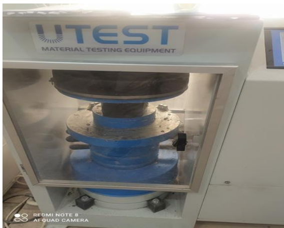
Figure 4. 18. Essai de compression avec une presse hydraulique.
