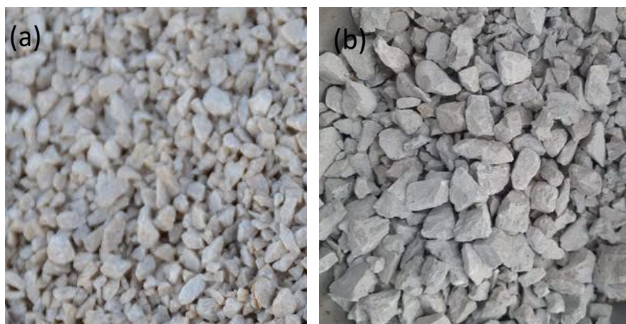
Figure 4. 6. Aspect visuelle du gravier naturel (a) et gravier recyclé (b)
