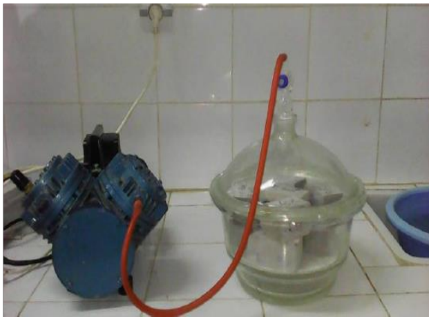
Figure 4. 16. Dispositif pour essai de porosité.
