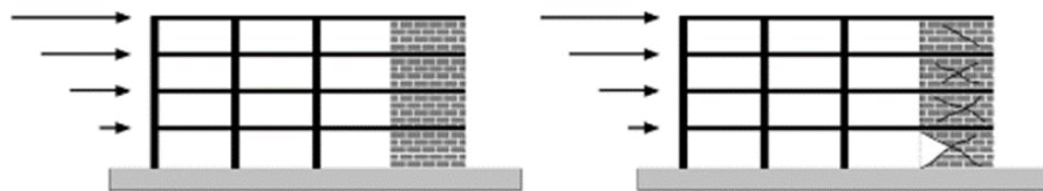
Figure I.9 : Contreventement par remplissage en maçonnerie [10]
