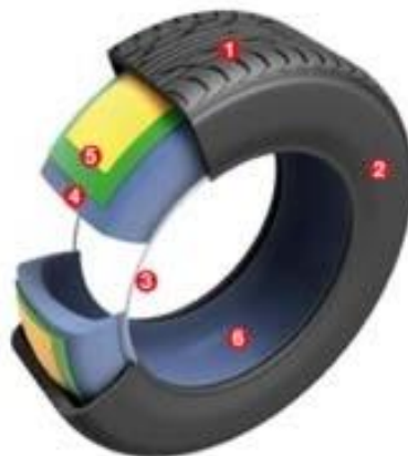
Figure 1.1 Vue en coupe des constituants d'un pneumatique (Moulin, 2018)
