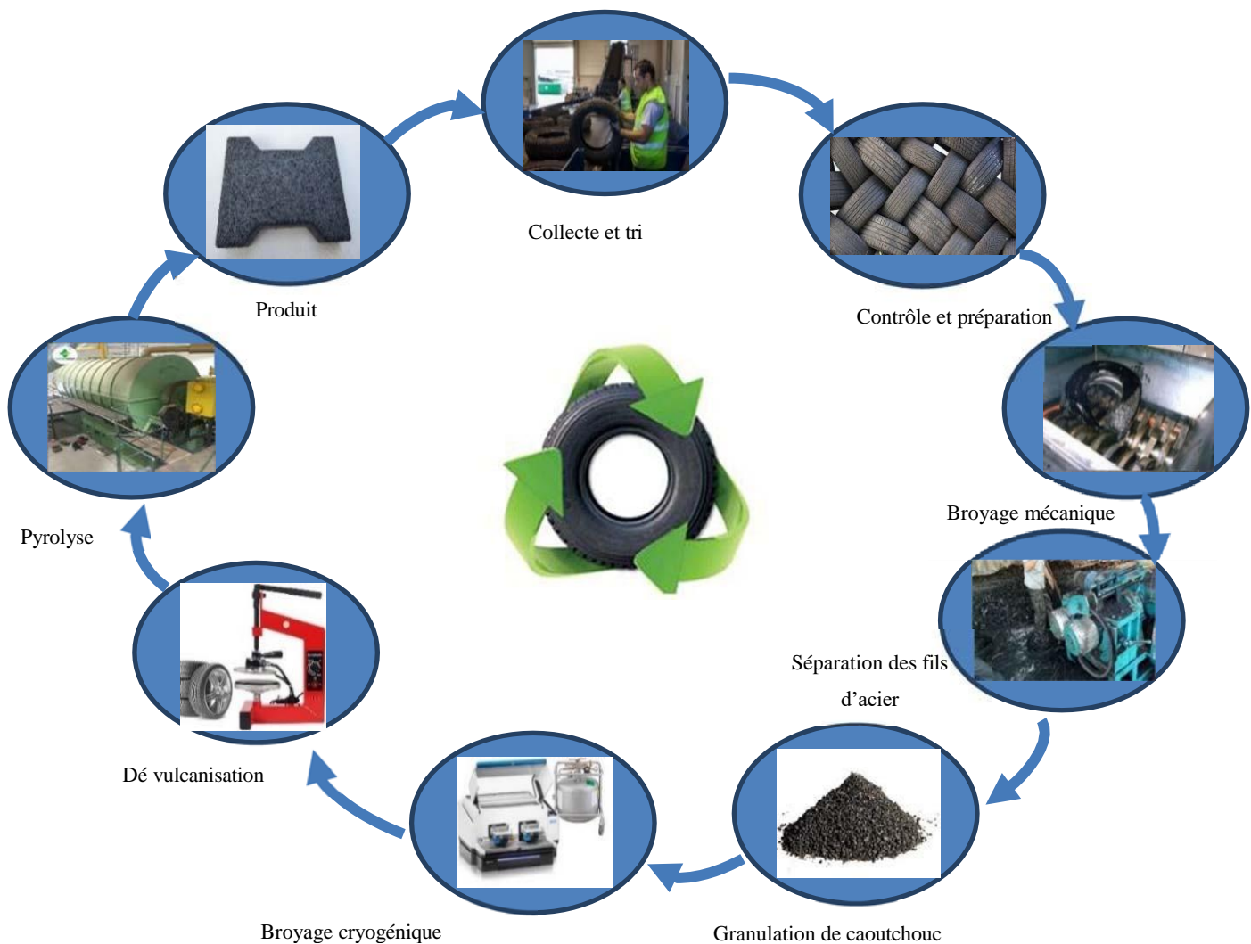
Figure 1.3 Le processus de recyclage des pneus
