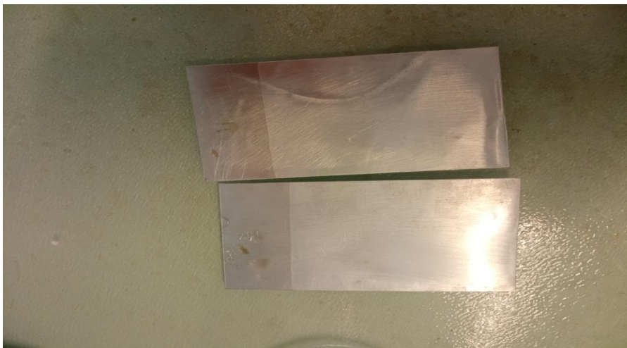
Figure III.3: Electrodes utilisée lors de travail (avant traitement).
