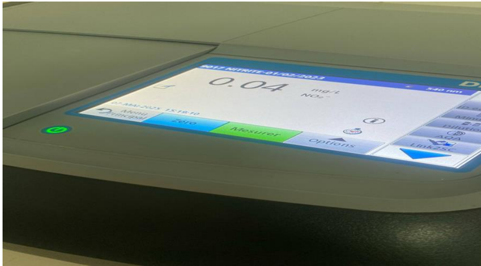
Figure III.8: Mesure de \text{NO}_2^- par UV-Vis
