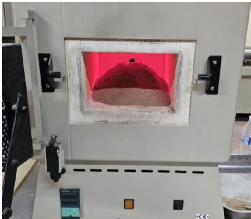
Figure 2. 5 : Calcination de la vase à 750\text{ °C} \pm 5\text{ °C} .
