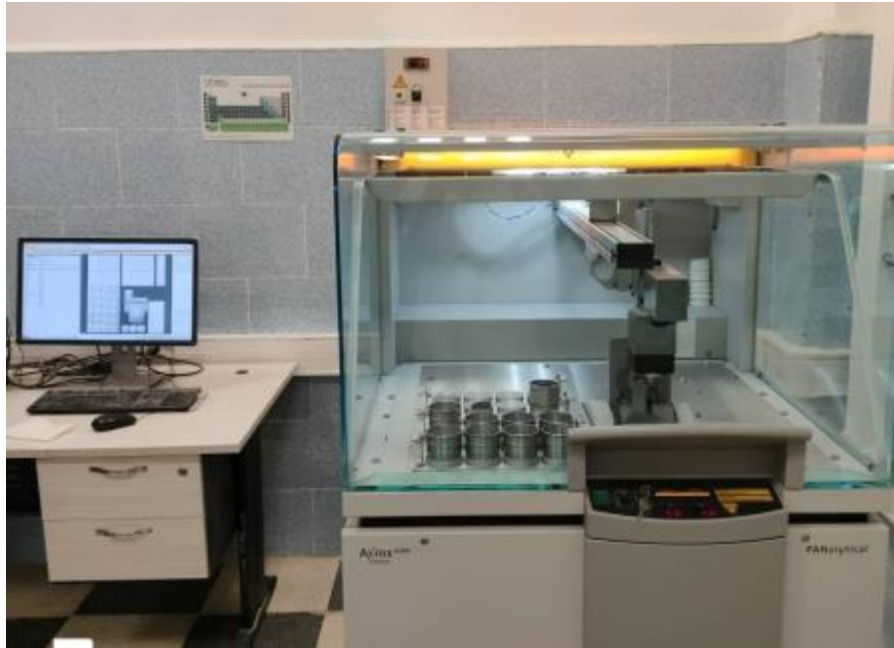
Figure 2. 10 : Essai de fluorescence des Rayons X.
