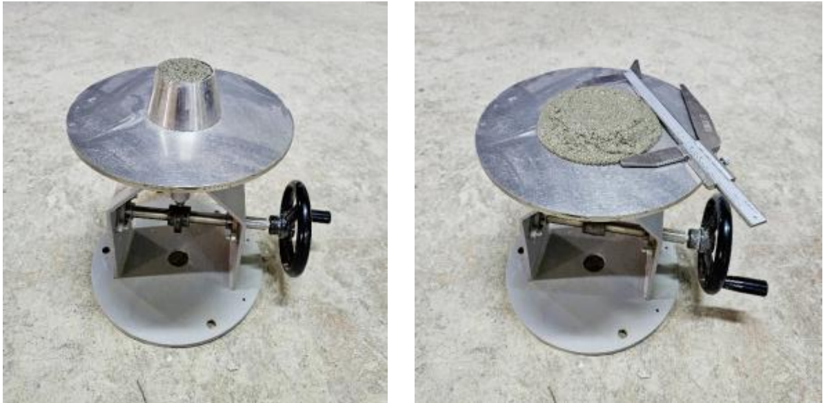
Figure 2. 16 : Mesure de l'étalement pour les mortiers à l'état frais.
