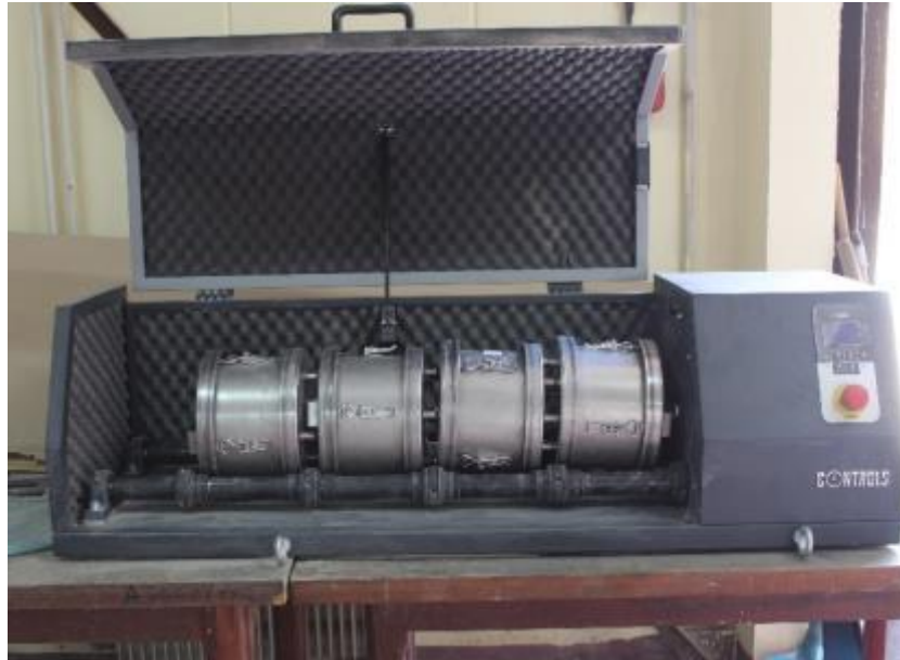
Figure 2. 4 : Broyage de la vase dans la machine Micro-Deval.
