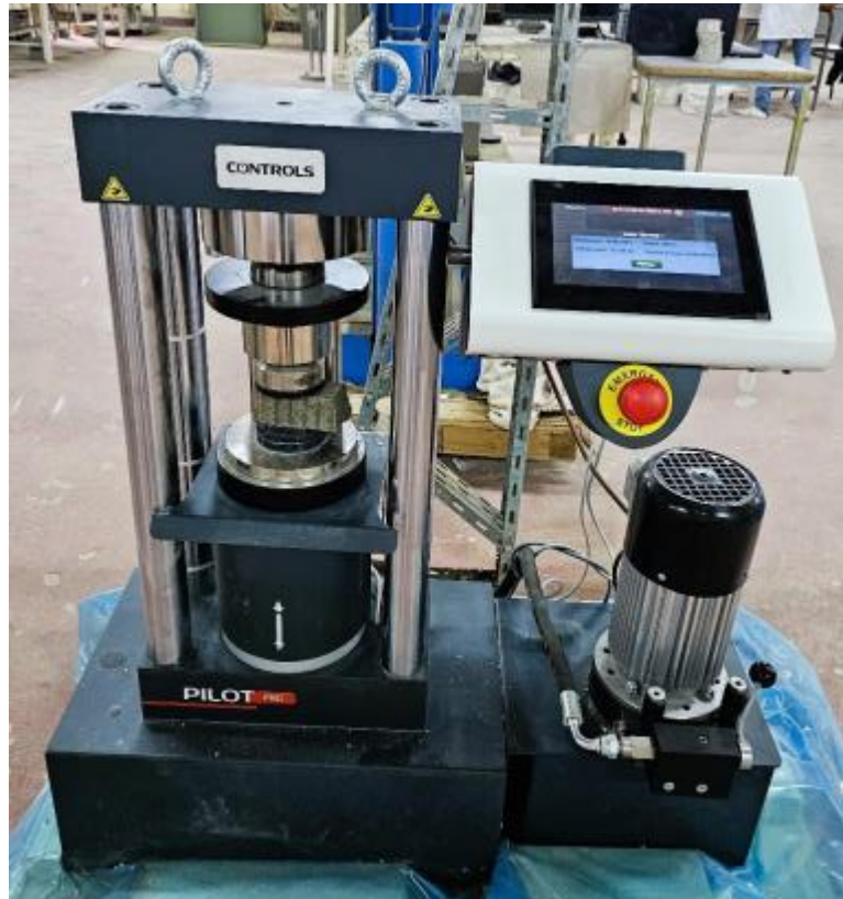
Figure 2. 20 : Essai de compression sur demi-prismes.
