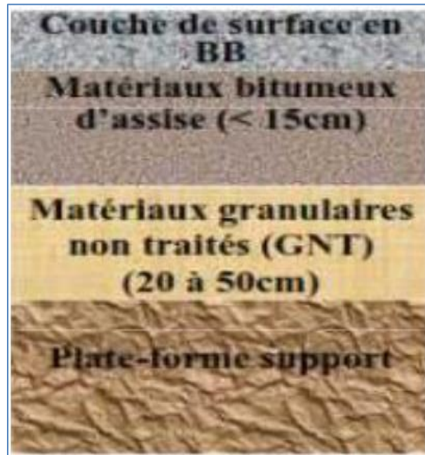
Figure 1.1 : Exemple d'une structure de chaussée souple [9].
