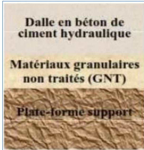
Figure 1.3 : Exemple d'une structure de chaussée rigide [9].
