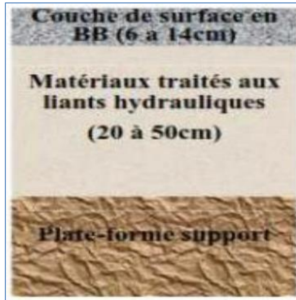
Figure 1.2 : Exemple d'une structure de chaussée semi-rigide [9].
