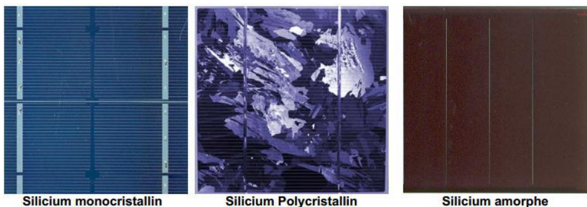
Figure I.4: Différents types de cellules photovoltaïques. [9]
