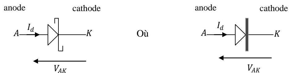
Fig IV-10. Symbolisation d'une diode Schottky
