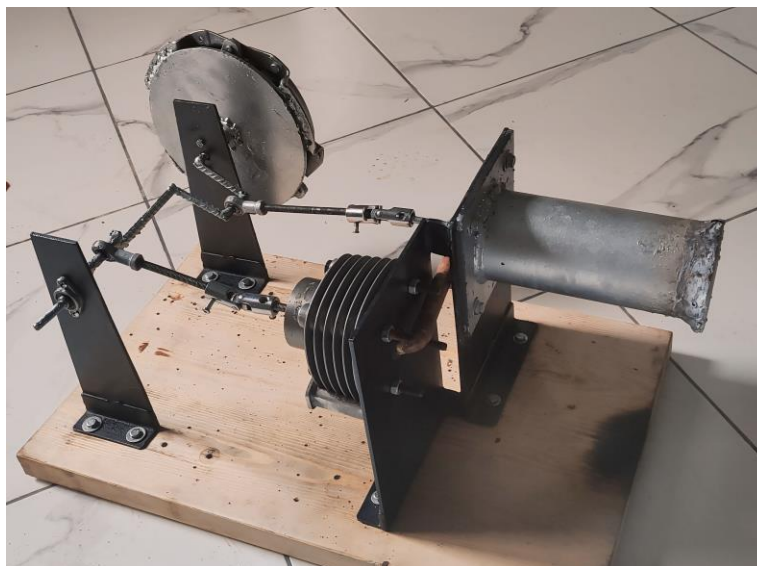
Figure 25 : Moteur Stirling d'un type Gamma \gamma
