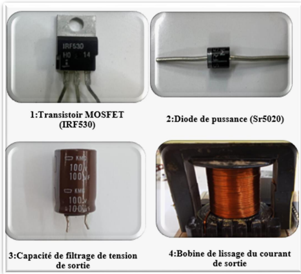
Figure III.10: Photos des composant de la carte de puissance.
