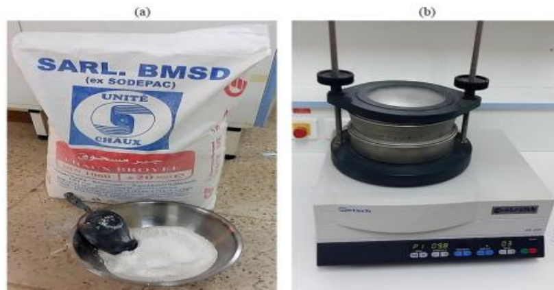
Fig. 4.2 — Préparation de la chaux. (a) Conditionnement de la chaux de Saïda, (b) Tamisage avec un tamis de 0,4mm.
