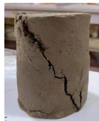
Fig. 4.16 — Fissures des surfaces latérales des éprouvettes après essais de compression
