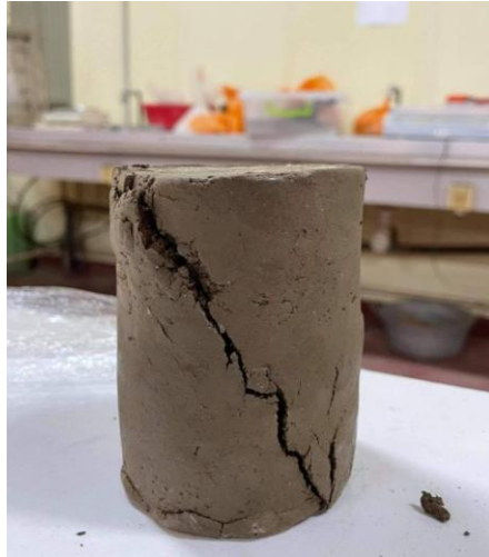
Fig. 5.37 — Fissures des surfaces latérales des éprouvettes après essais de compression.
