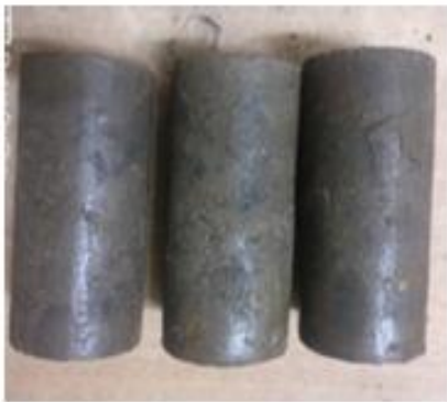
Fig. 2.9 — Rupture de l'échantillon optimisé après 28 jours de cure (Khushbu S. et al. 2019)
