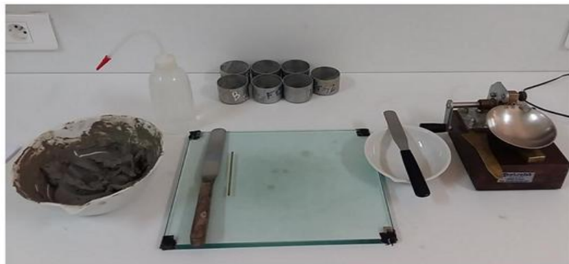
Fig. 4.6 — Dispositif utilisé dans le test limite d'Atterberg selon ASTM D 4318-17 .
