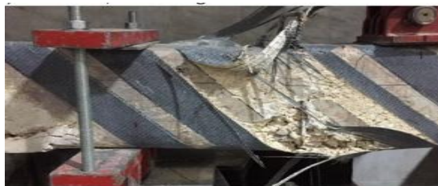
Rupture du composite CFRP [68].
