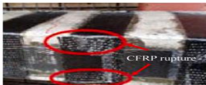
Rupture du composite CFRP [65].
