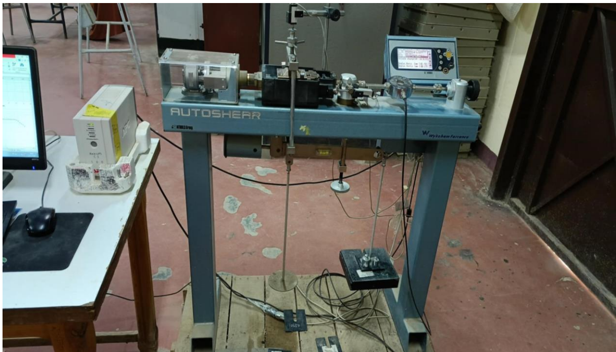
Figure 2.1 : Appareil de cisaillement utilisé dans cette étude.
