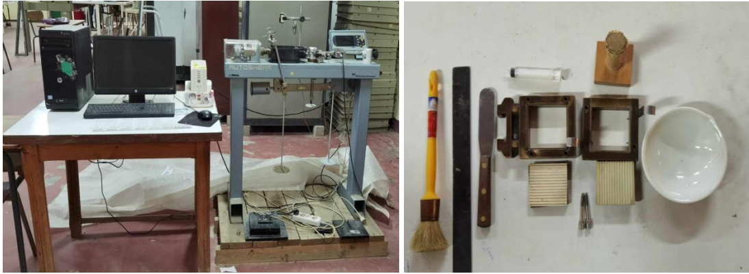
Fig. II.11. (a) L'appareil de cisaillement de laboratoire MDS université Chlef ; (b) Matériels supplémentaires utilisés pour la préparation des échantillon
