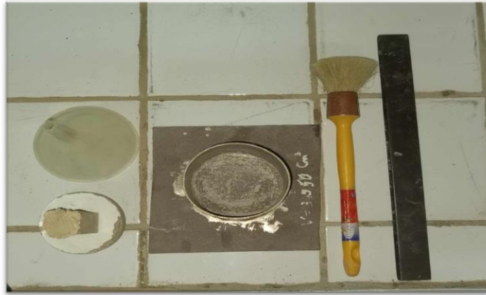
Fig. II.6. Matériaux utilisé pour déterminer les masses volumiques minimales et maximales.
