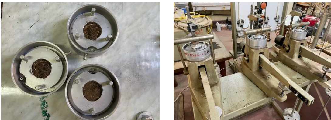
Fig. II.13. L'appareil de l'essai œdométrique laboratoire MDS université Chlef
