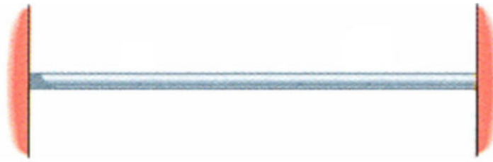
Figure I. 3: Tige en acier fixé entre deux murs.
