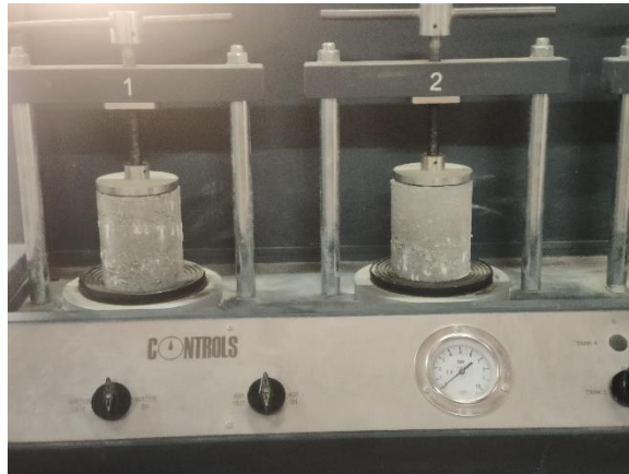
Figure 2. 29. Essai de perméabilité à l'eau.
