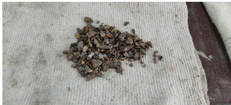
Figure 2. 21 . Vue sur le séchage des granulats avec un chiffon.
