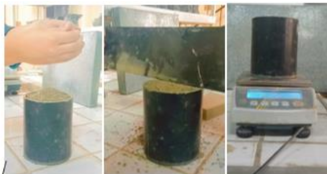
Figure 2. 11. Vue de l'essai de masse volumique apparente.
