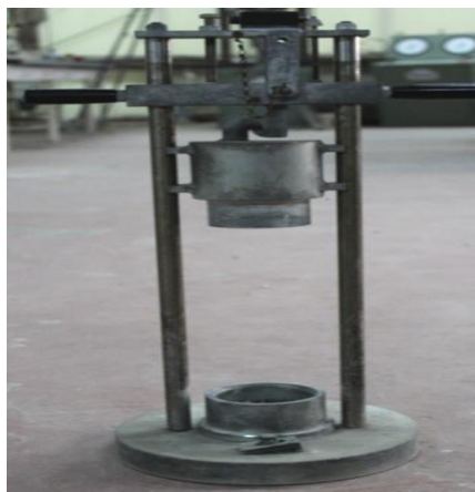
Figure 2. 17. Essai de fragmentation dynamique
