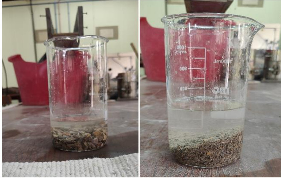
Figure 2. 20. Vue de l'immersion des granulats dans l'eau.
