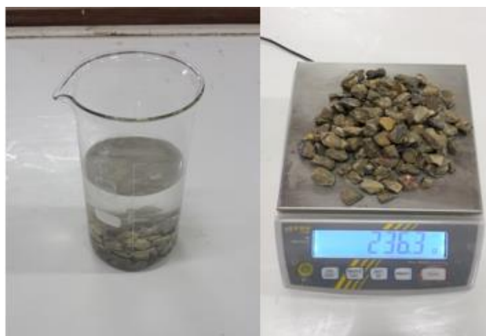
Figure 2.13. Essai de coefficient d'absorption de granulats.
