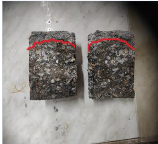
Figure 3. 7. Faciès de profondeur de pénétration d'eau de BCR à 28 jours.
