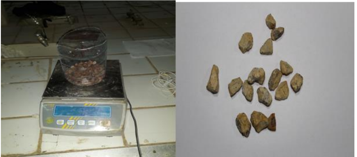
Figure 2. 18. Méthode de la dissolution dans l'acide Chloridrique.
