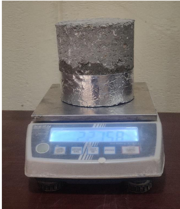
Figure 2. 27. Essai d'absorption d'eau par capillarité.
