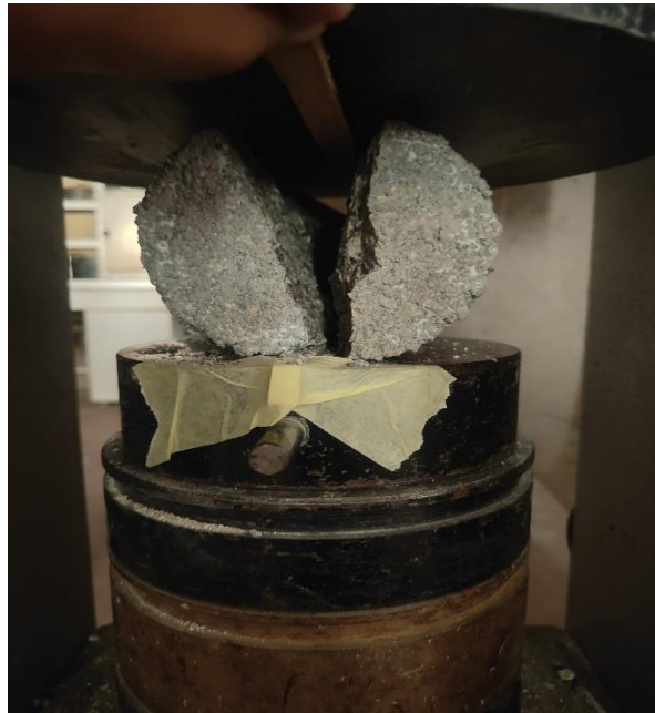
Figure 2. 26. Essai de fendage.
