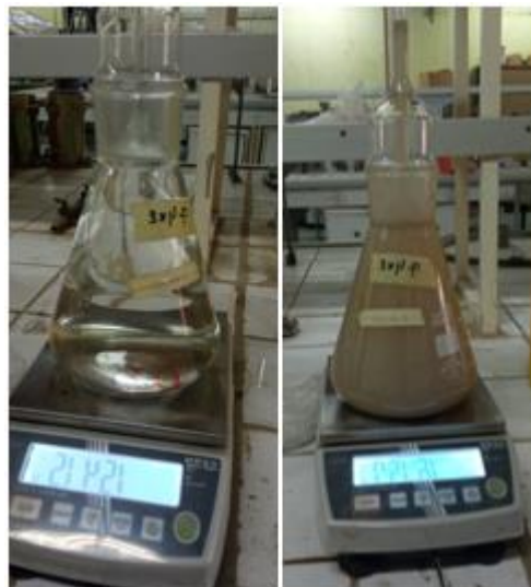
Figure 2.12. Pycnomètre utilisé pour déterminer la masse volumique absolue d'un sable.
