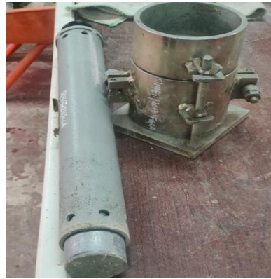
Figure 2.22. Dam de compactage et le moule Proctor standard.
