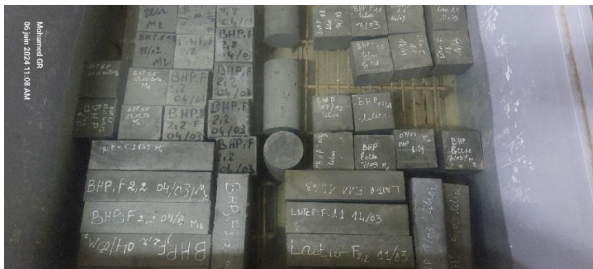
Figure 2. 13. Conservation des éprouvettes dans un bac d'eau.
