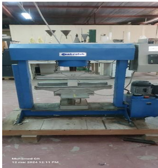
Figure 2. 17. Dispositif expérimental pour l'essai de traction par flexion.
