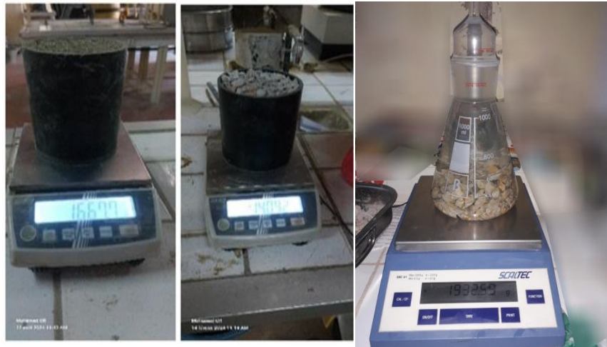
(a) masse volumique apparente (b) masse volumique absolue Figure 2. 9. Essai de masse volumique (Sable et Granulat).
