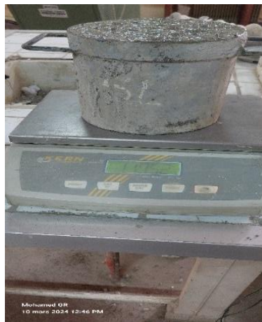
Figure 2. 15. Mesure de la masse volumique du BHP frais.
