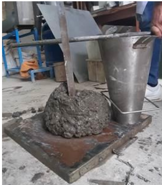
Figure 3. 1. Affaissements des bétons.
