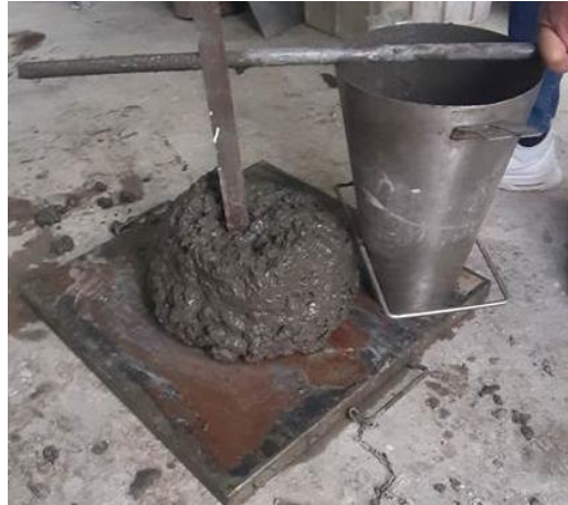
Figure 2. 14. Essai d'affaissement au cône d'Abram
