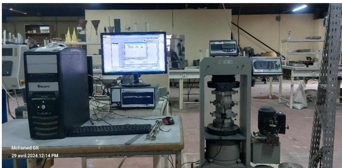
Figure 2. 18. Mesure du Module d'élasticité.
