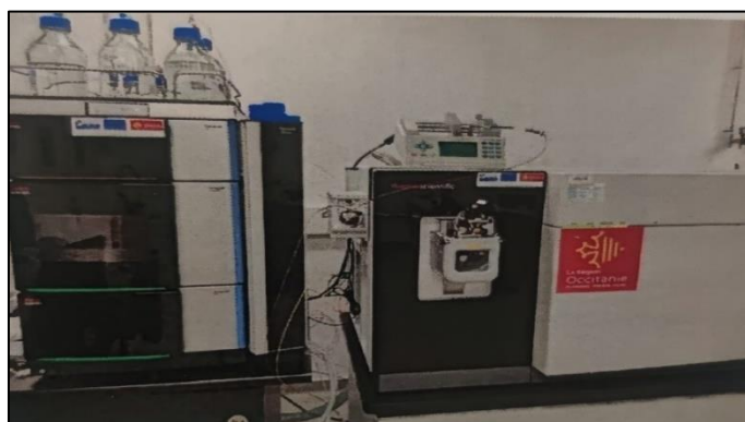
Figure II.9 : Chromatographie liquide à ultra haute performance couplée à une spectrométrie de masse à haute résolution de la Plateforme d'Analyse et de Caractérisation (PAC) du Pôle Chimie Balard, Montpellier
