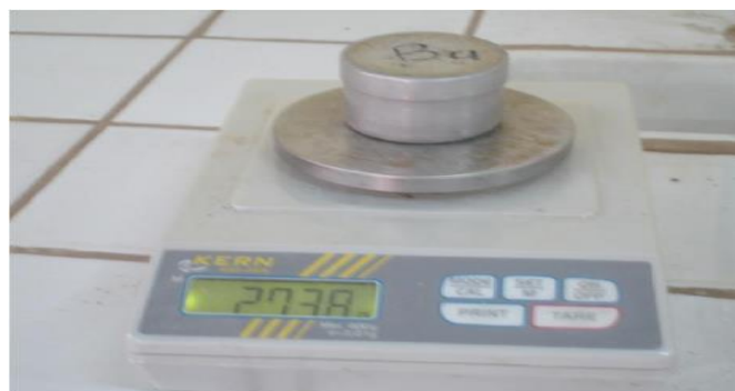
Figure 3.11: Prélèvement pour la mesure de la teneur en eau.
