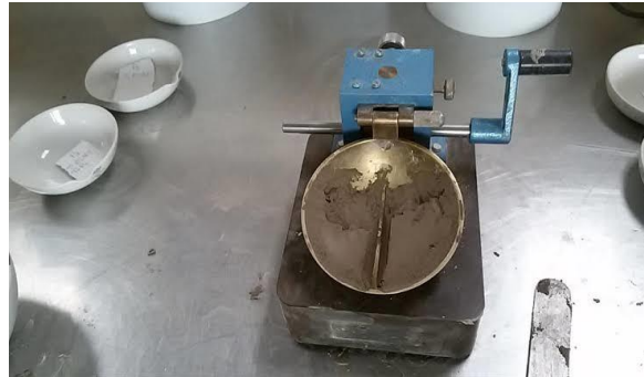
Figure 3.10: Remplissage de la coupelle et réalisation de la rainure
