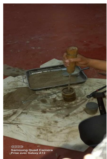
compactage partiel manuel
