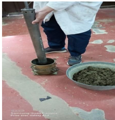
Fig.3.15 : Compactage des éprouvettes
