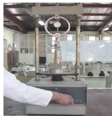
Compactage final à la presse
