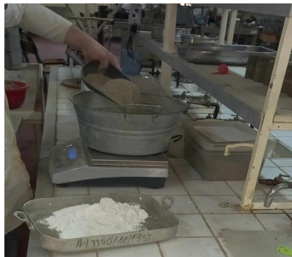
Fig.3.25 : Mélange de chaux et d'argile
