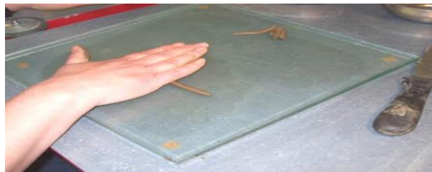
Fig.3.12: Confection du rouleau pour la détermination de la limite de plasticité
