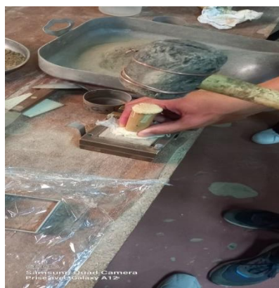
Compactage partiel manuel
