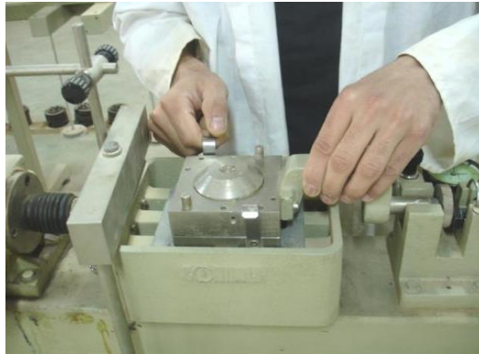
Fig.3.20 : Mise en place de l'éprouvette
