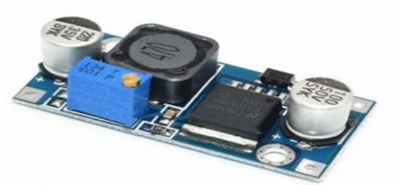
Figure II.18. Module Régulateur DC-DC Step Down LM2596
