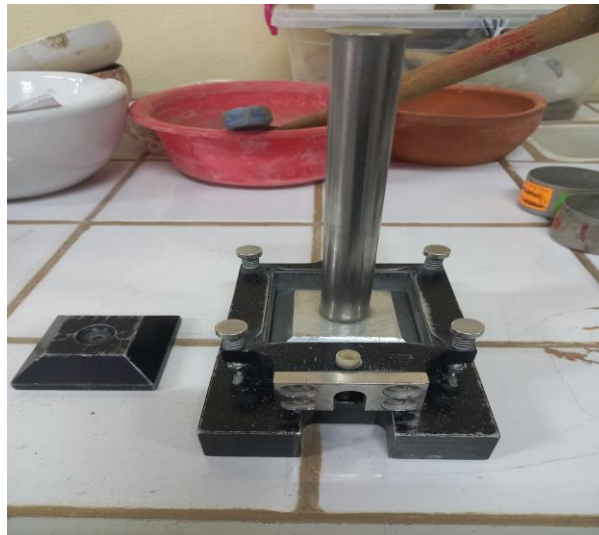
Figure 2.8 : méthode de préparation des échantillons (Etat dense)
