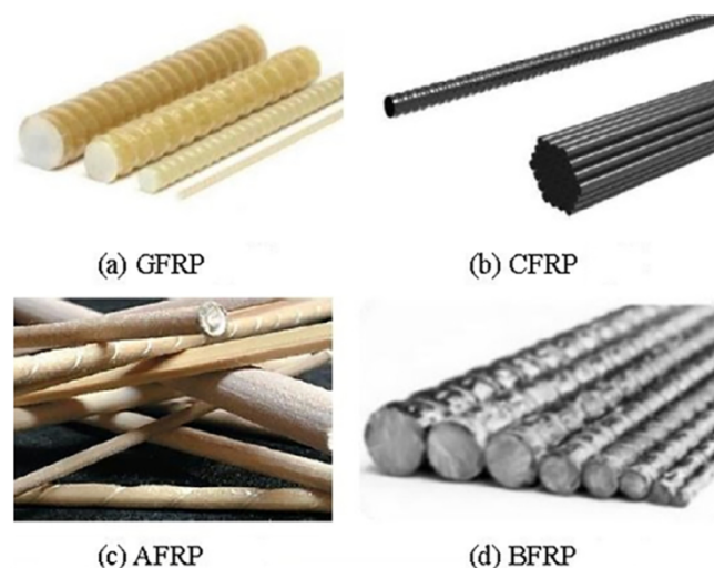
Fig. 1.2 — Quatre types de barres en FRP (Abbood et al., 2021).
