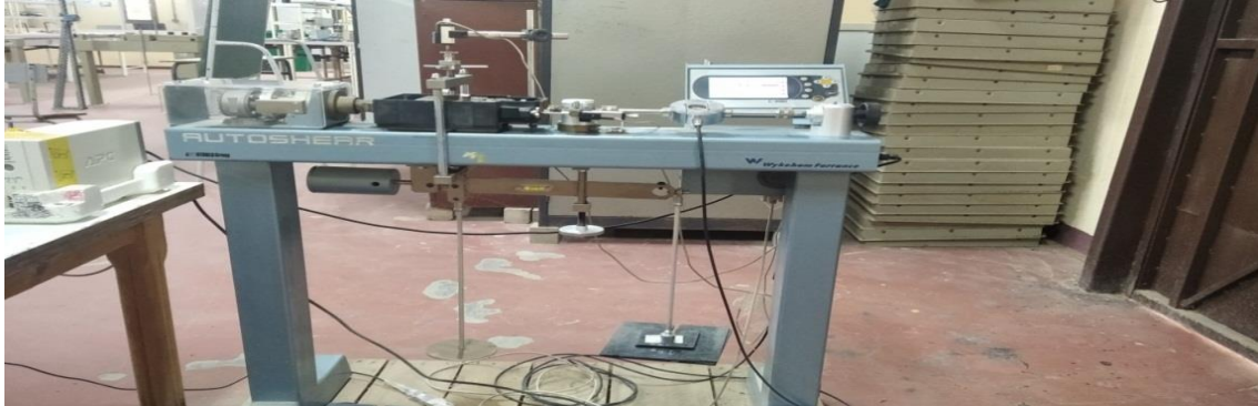
Figure 3.9: Boîte de cisaillement direct utilisée
