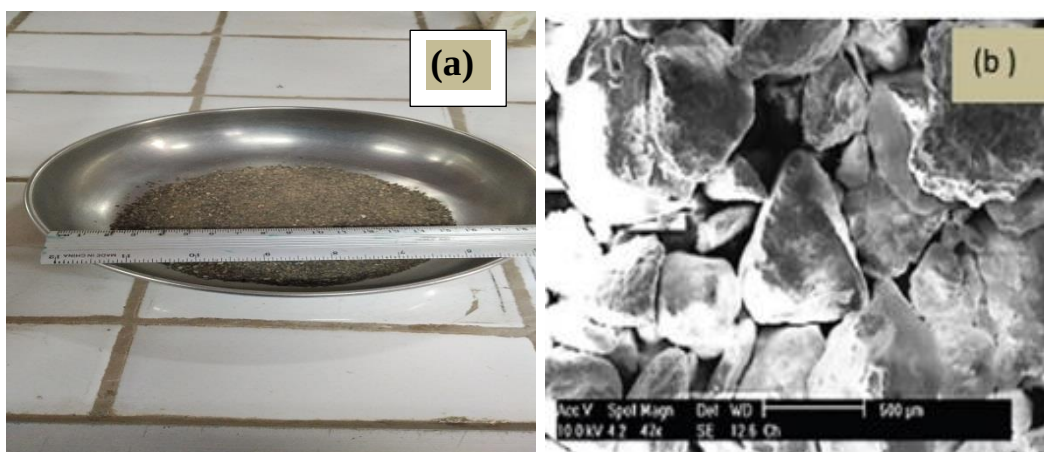
Figure 3. 2 : a) Sable de Chlef ; b) Microscope électronique à balayage (SEM) Vue de sable testé : Affichage de la taille de particule et la forme de sable de Chlef, (Belkhatir et al. 2010).
